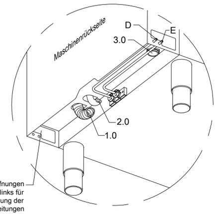
Optionale Öffnungen rechts/links für Verlegung der Anschlussleitungen
